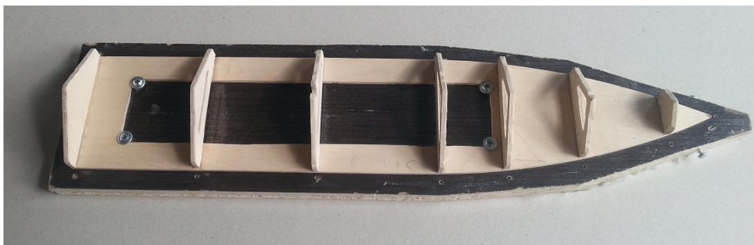
9 pav. Pritvirtintas denis prie stapelio su priklijuotais špantais.
