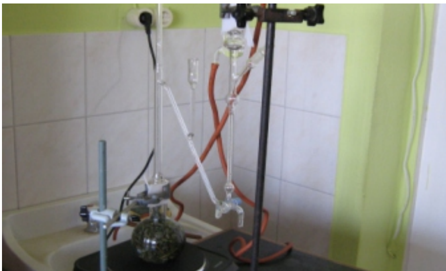
2 pav. Eterinių aliejų hidrodistiliacijos sistema.
